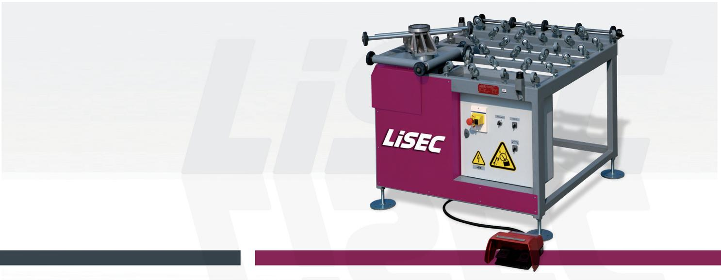
Die doppelte Saugerplatte sorgt für ein optimales Fixieren der Elemente während des Versiegelungsvorganges. Die gleiche Höhe des Tisches mit den Transportstrecken gewährleistet das einfache Positionieren und Abziehen der Elemente. Die versiegelten Scheiben werden automatisch auf das Tischniveau abgesenkt. Vier ausziehbare Teleskoparme für groß dimensionierte Isolierglaselemente.
